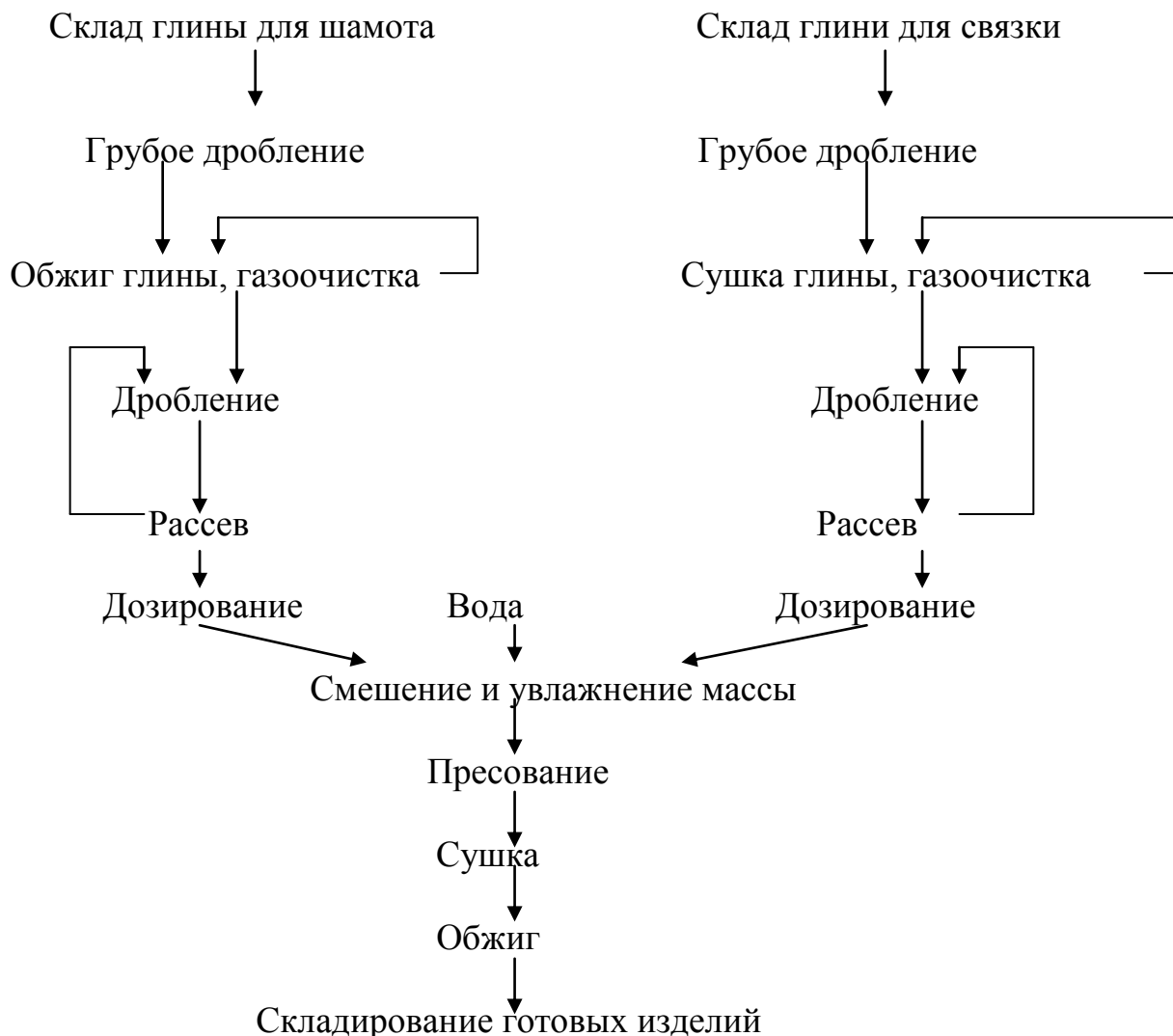
Рисунок 4.1 - Технологическая схема производства шамотных изделий
